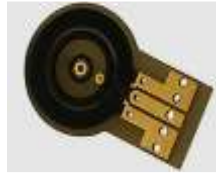
Fig. 1: A precision potentiometer HWL60
